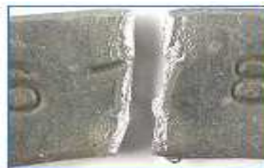
Bruchverlauf durch Zifferneinprägung begünstigt
